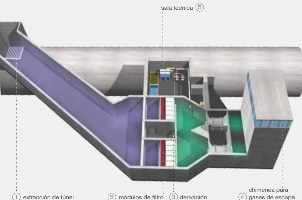
Las partículas peligrosas se eliminan específicamente antes del final del túnel, para que no puedan salir al aire libre ①.
