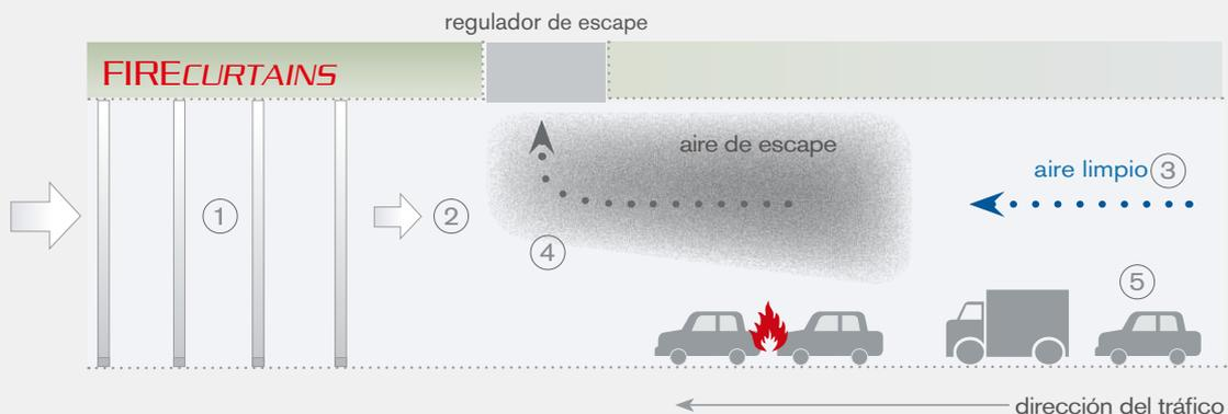
FIRECURTAINS, una vez activadas, ① aumentan la resistencia del caudal de aire hacia el portal de salida, por lo tanto reducen enormemente la presión del viento ②. Así el sistema de aspiración del incendio puede extraer en su mayoría el portal de la boca de entrada ③, y por tanto eliminando el humo que se genera ④. Los vehículos detenidos permanecen ahora (al contrario que en la situación sin FIRECURTAINS) sin humo y seguros ⑤!
