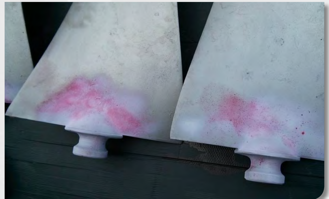
Prüfung Laufradschaufeln mittels Farbeindringverfahren
