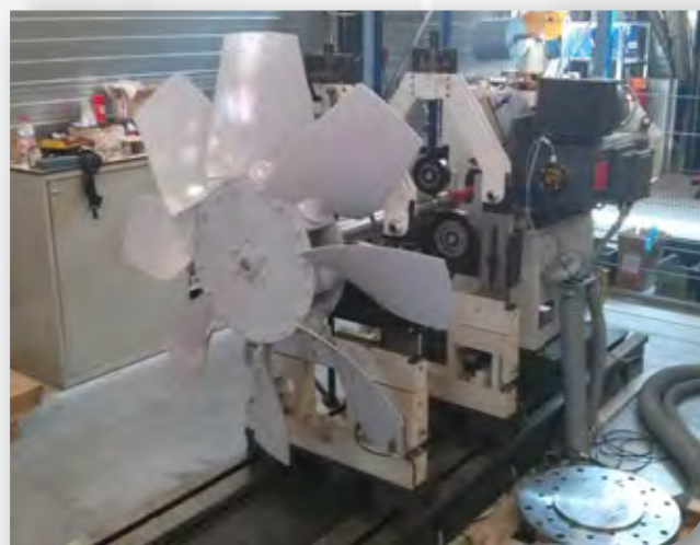
Auswuchten Laufrad auf eigenen Auswuchtbank
