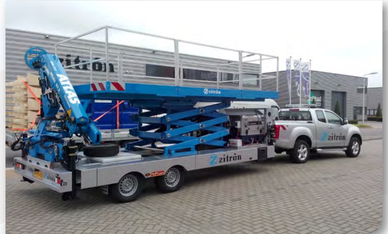
Fifthwheel Pick-up Truck für De- und Montage sowie Inspektion von Strahlventilatoren
