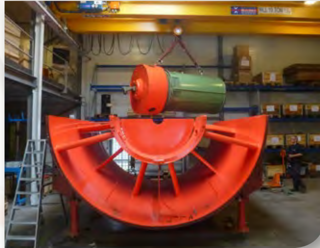
Montage E-Motor mit Laufrad im Ventilatorgehäuse
