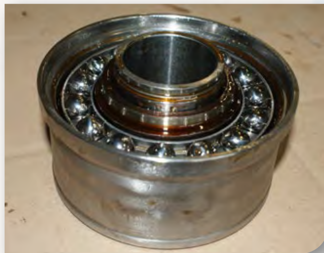
Ölbadgeschmiertes gegenläufiges Holmlager
